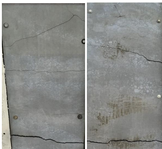
3.47 pav. Bandinių paviršiaus vaizdas po atsparumo ugniai bandymo (3 kartų didinimas): E1 bandinys (a), E3 bandinys (b) (2 kartų didinimas)
