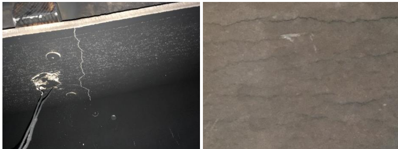
3.48 pav. Bandinių paviršiaus vaizdas po atsparumo ugniai bandymo: MKS50 1 bandinys (a), C10 2 bandinys (b) (2 kartų didinimas)
