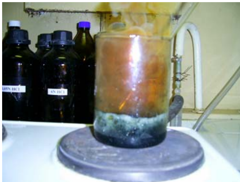
2.5 pav. Cezio nuosėdų šlapiasis deginimas \text{H}_2\text{SO}_4 ir \text{HNO}_3 rūgščių mišinyje
