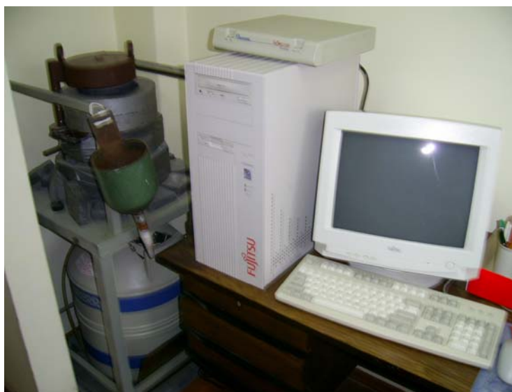
2.7 pav. Gama spektrometras su puslaidininkiniu HPGe detektoriumi CANBERRA prijungtas prie personalinio kompiuterio
