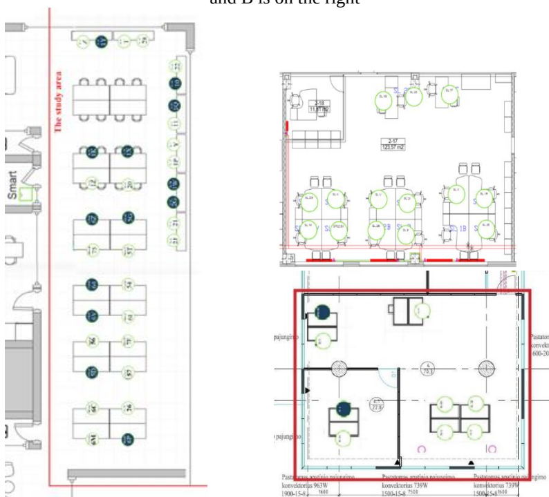
2.3. pav. Tiriamųjų patalpų darbo vietose sumontuotų PIR daviklių planai.
