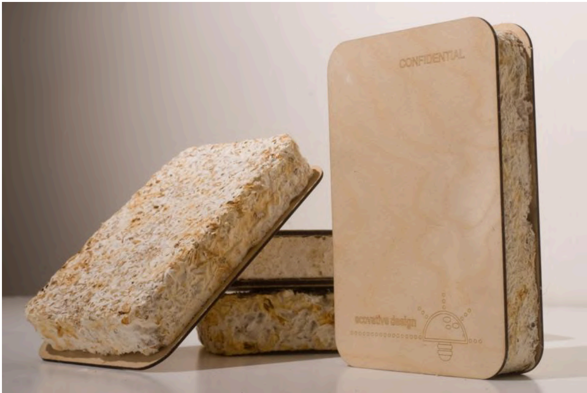
15 pav. Iš grybienes sukonstruotos pastatų apšiltinimo medžiagos “Greensulate”.
