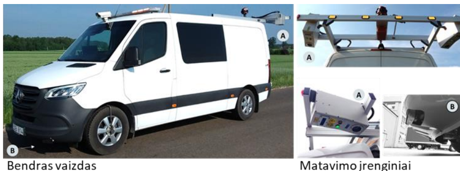
2.8 pav. Mobilioji kelių tyrimų įranga RST63:
