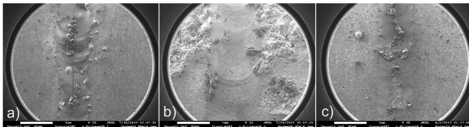
3.8 pav. Lazeriu apdorotų paviršiaus takelių nuotraukos: a) be išankstinio pagrindo pakaitinimo – 20 °C, b) su išankstiniu pagrindo pakaitinimu iki 200 °C, c) su išankstiniu pagrindo pakaitinimu iki 400 °C (be lazerio spindulio skersinių svyravimų – 0 mm, lazerinio apdorojimo greitis – 1000 mm/min)
