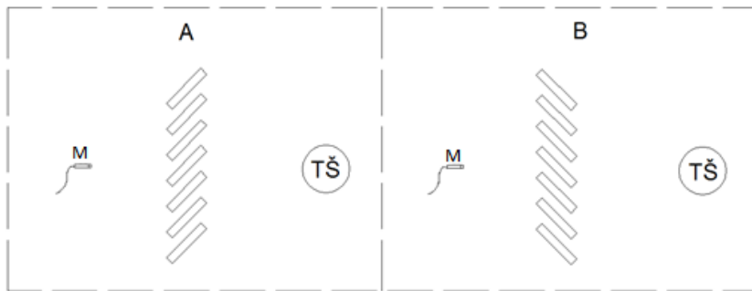
2.16 pav. A – plokštės, atsuktos nuo triukšmo šaltinio; B – plokštės, atsuktos į triukšmo šaltinį; TŠ – triukšmo šaltinis; M – mikrofonas
