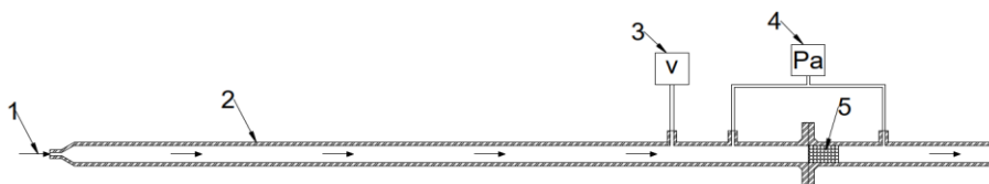
2.5 pav. Principinė orinės varžos matavimo prietaiso schema: 1 – oro srautas iš kompresoriaus; 2 – oro tekėjimo vamzdis; 3 – oro greičio matuoklis; 4 – slėgio skirtumo matuoklis; 5 – tiriamasis bandinys
