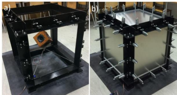
1.7 pav. Garsą izoliuojantis gaubtas: a – plieninis karkasas be sienų ir su įvairiakrypčiu garso šaltiniu; b – plieninis karkasas su sienelėmis iš mineralinės vatos ir aliuminio derinio (Kosala et al., 2020)
