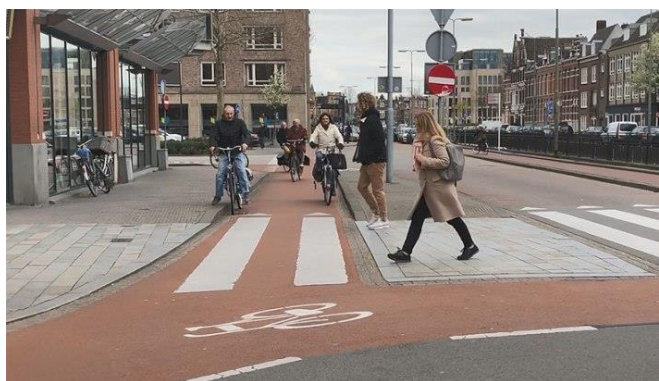
4.2 pav. Pėsčiųjų perėjos dviračių take pavyzdys, Olandija ( www.bicycledutch.wordpress.com )
