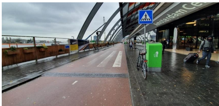
4.7 pav. Iškilios pėsčiųjų perėjos dviračių take pavyzdys, Olandija (nuotr. Jono Simučio)
