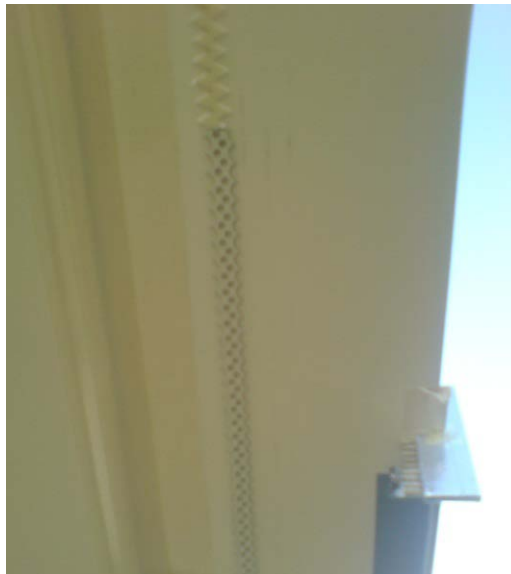
3.17 pav. Suprojektuotas dirbtinis trikdys ant LAK-17B sklandytuvo sparno prieš skrydį (vaizdas iš sparno apačios)
