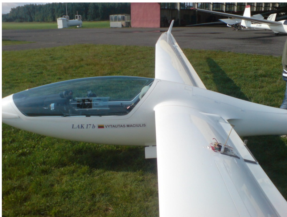
3.5 pav. Ekspimentinė įrangą ant sklandytuvo LAK-17B sparno
