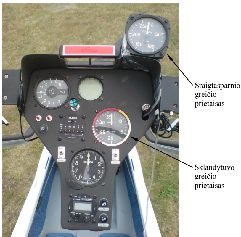
3.6 pav. LAK-17B sklandytuvo prietaisų lenta ir matavimams naudotas sraigtasparnio greičio prietaisas
