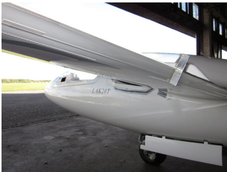
3.9 pav. Integruojančios pėdsako šukutės ant sklandytuvo LAK-20T sparno prieš skrydį Fig 3.9. Installation of integrating wake rake on the wing trailing edge of the LAK-20T sailplane before free flight
