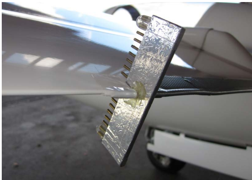
3.4 pav. Pėdsaką integruojančios šukutės ant sklandytuvo sparno
