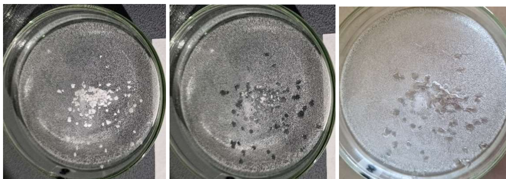
2.18 pav. Kietosios būsenos \text{CaCl}_2 ledo tirpdyimo bandymas esant -3\text{ }^\circ\text{C} (a) – ką tik paskleidus, b) – 5 min po paskleidimo, c) – po sausinimo)
