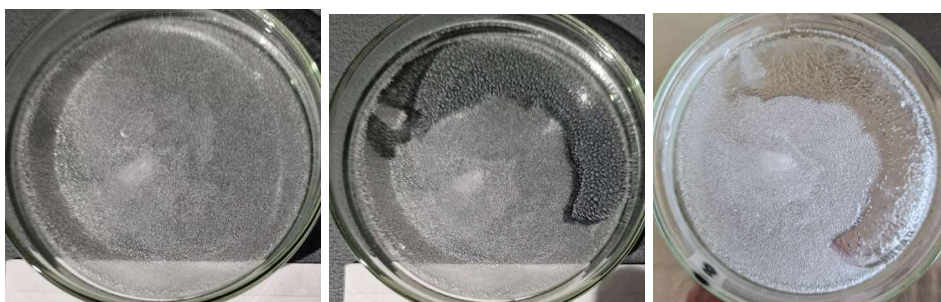
2.19 pav. „Nordway KF“ tirpalo ledo tirpdyimo efektyvumo bandymas prie -10\text{ }^\circ\text{C} (a) – ką tik paskleidus, b) – 60 min po paskleidimo, c) – po sausinimo)
