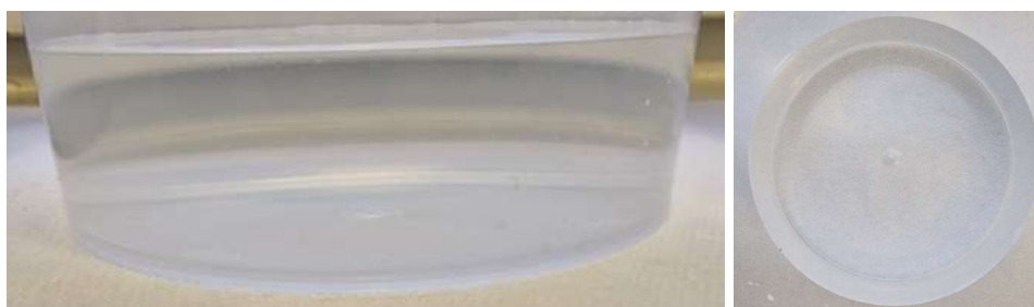
2.11 pav. „Nordway KF“ (skystas) tirpalas „Nordway KN“ (granulės) tirpalas: granulės pilnai ištirpo, tirpalas gavosi skaidrus. Po paros iškrito labai mažas kiekis smėlio spalvos nuosėdų, tirpalas skaidrus.
