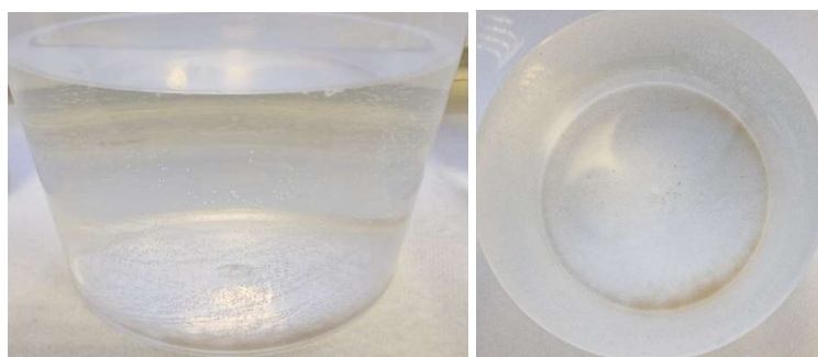
2.12 pav. „Nordway KN“ (granulės) tirpalas Natrio acetato tirpalas: pilnai ištirpo, skaidrus, ant sienelės pirmą valandą po paruošimo laikėse labai daug oro burbulėlių. Po paros pilnai ištirpo, skaidrus, šiek tiek liko oro burbulėlių. Tai vienintelis tirpalas, kuris užšaldavo aukštesnėje nei -10^{\circ}\text{C} (bet ne aukščiau nei -6^{\circ}\text{C} ) įnešus jį į šaldymo kamerą.
