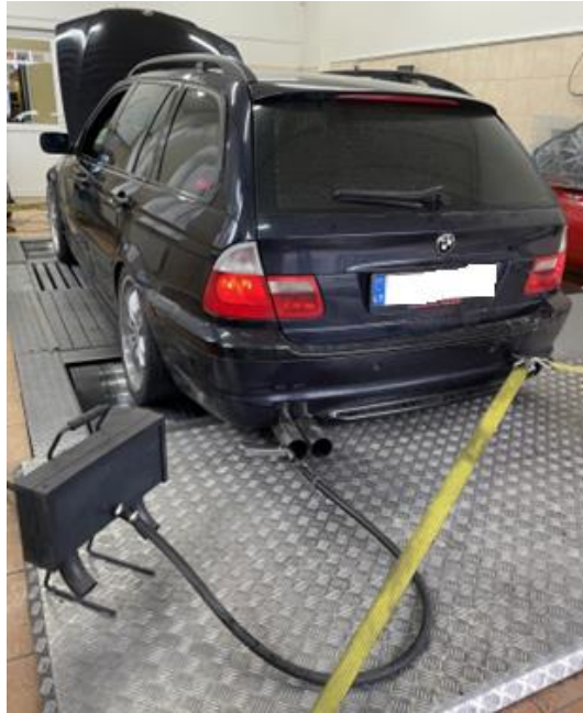
8 pav. BMW E46 330D dūmingumo matavimas ir emisijų analizavimas, naudojant specialią diagnostiką, esant apkrovai
