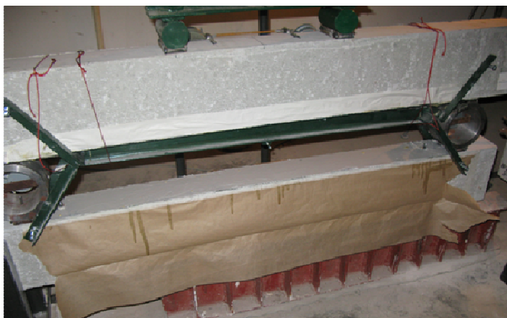
3.4 pav. Tempiamo paviršiaus išlyginimas epoksidiniu glaistu „Mapewrap 11“
