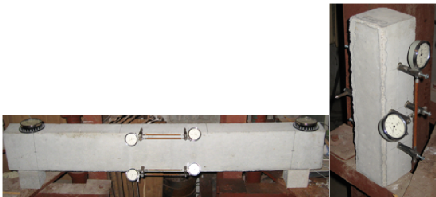
3.10 pav. Traukumo deformacijų matavimas kontroliniuose bandiniuose Fig. 3.10. Measurement of shrinkage deformations on control specimens
