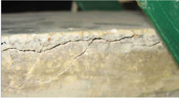
1.2 pav. Plyšių vystymosi charakteris virš kompozitinio sluoksnio Fig. 1.2. Evolution of horizontal cracks above the composite layer
