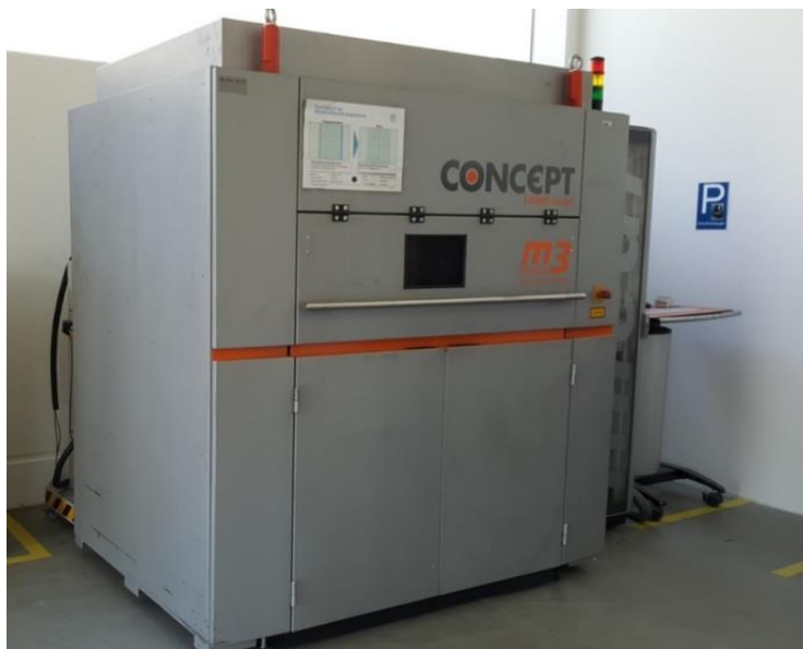
4 pav. Concept Laser M3 selektyviojo lazerinio sulydymo įrenginys
