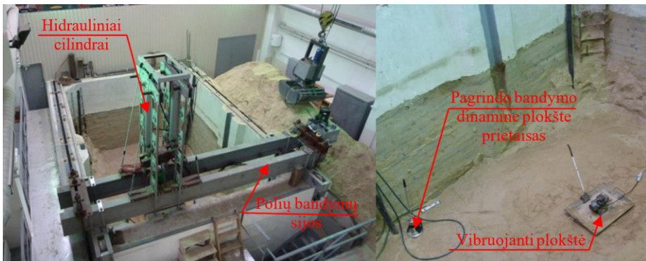
2.1 pav. Dirbtinai suformuoto pamatų pagrindo dėžė ir tyrimams naudotos įrangos schema
