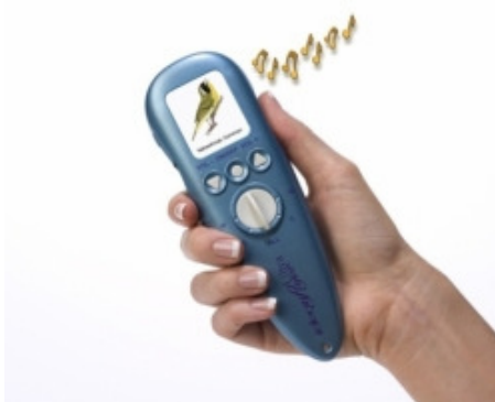
2.9 pav. IdentiFlyer Ultra paukščių atpažinimo pagal jų giesmę įtaisas [13]
