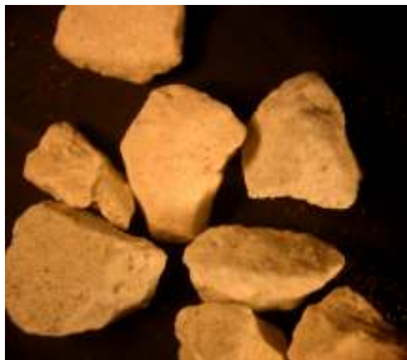
1.4 pav. Gamtinis ceolitas – klinoptilolitas, frakcija 1,0–3,0 mm. Vaizdas padidintas 10 kartų
