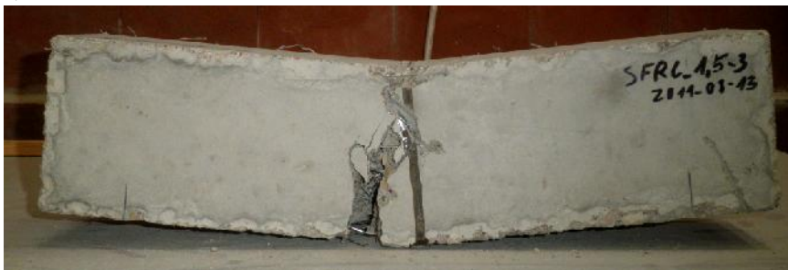
4.4 pav. Lenkiamų bandinių suirimo pobūdis, kai betonas be fibrų (a) ir su fibromis (b)
