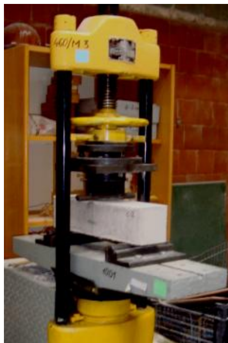
4.3 pav. Eksperimentinis bandinių lenkimo stiprio nustatymas; a – bandymo ir prietaisų išdėstymo schema (1 – įlinkiamatis); b – eksperimento eiga
