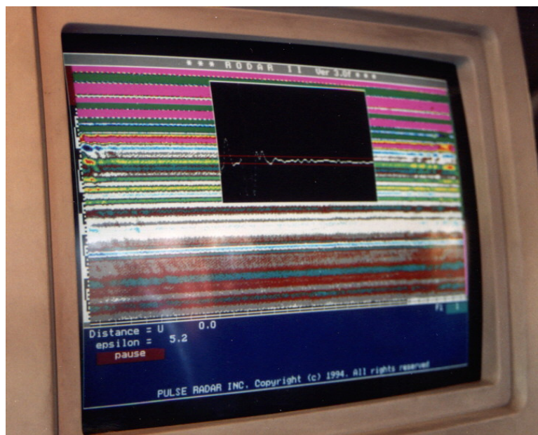
3.6 pav. Kompiuterio monitoriuje – pirminis tyrimų rezultatų georadaru vaizdas
