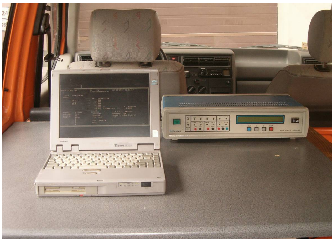
3.3 pav. Kompiuterizuota darbo vieta deflektometrui „Dynatest FWD 8000“ valdyti
