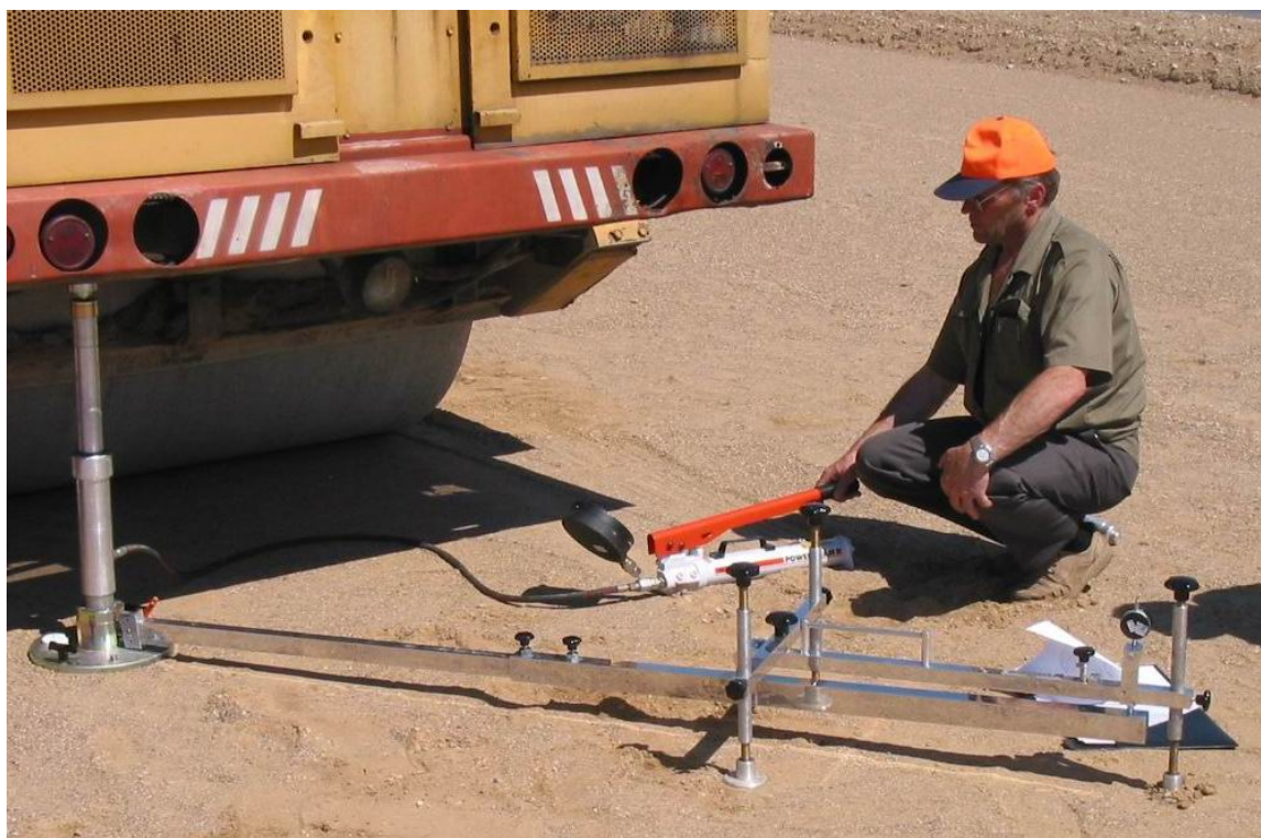
1.1 pav. Matavimas statine sija „Strassentest“
