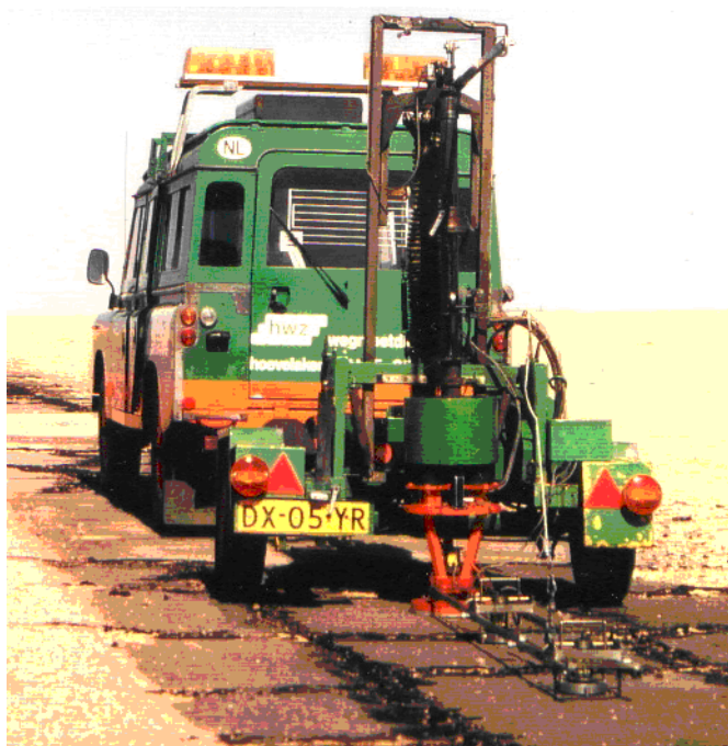
1.4 pav. „Phonix“ kompanijos pagamintas FWD su „Dynatest“ kompanijos elektronine sistema
