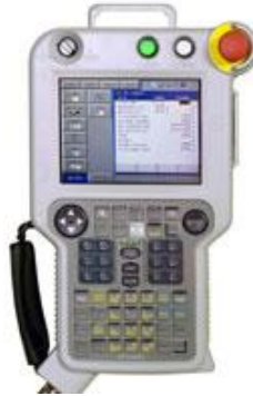
8 pav. Roboto „Motoman SSF2000“ valdymo bloko NX100 nešiojamas valdymo pultas
