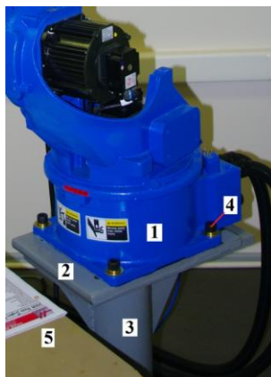
2 pav. Manipulatoriaus stovas: 1 – manipulatoriaus pagrindas; 2 – metalinė plokštelė; 3 – stovas; 4 – varžtai (4 vnt.); 5 – darbo stalas
