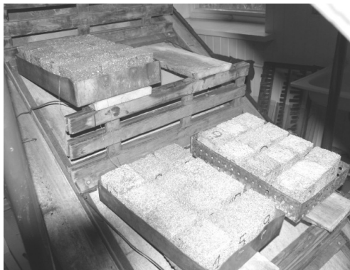
2.13 pav. 250 kg/m 3 tankio kompozitinės medžiagos bandiniai eksperimento metu Fig. 2.13. Composite material samples with density of 250 kg/m 3 during experiment
