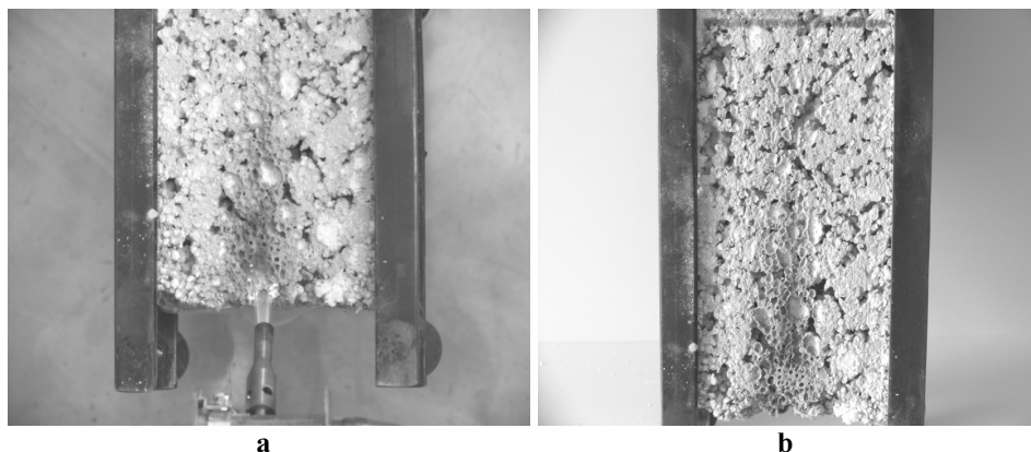
5.28 pav. 250 kg/m 3 tankio kompozitinės medžiagos bandinys eksperimento metu (a) ir po jo (b)
