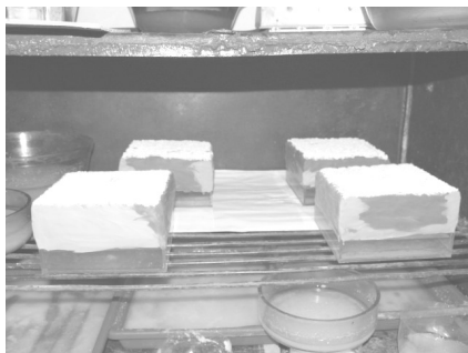
2.11 pav. 250 kg/m 3 tankio kompozitinės medžiagos bandiniai eksperimento metu
