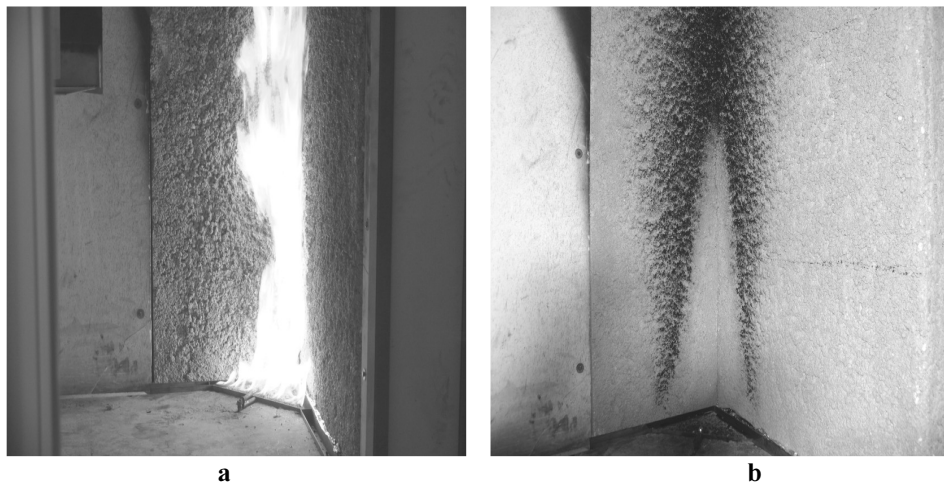
5.29 pav. 250 kg/m 3 tankio kompozitinės medžiagos bandinys eksperimento metu (a) ir po jo (b)
