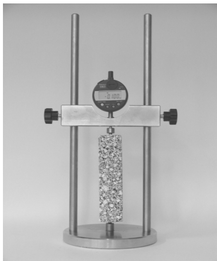
2.12 pav. 350 kg/m 3 tankio kompozitinės medžiagos bandinys eksperimento metu
