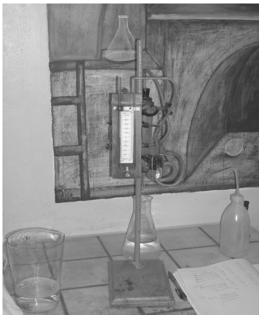
2.2 pav. Vandeninio APM tirpalo paviršiaus įtempio matavimas Fig. 2.2. Measurement of surface tension of surfactant water solution
