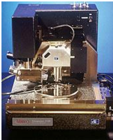
2.4 pav. „Dimension 3100“: skiriamoji geba 5 nm [25]
