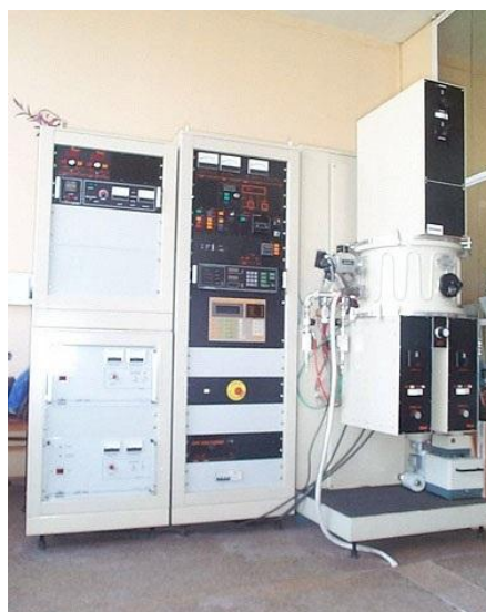
2.3 pav. 3 šaltinių magnetroninio dulkinimo įrenginys SCM [30]
