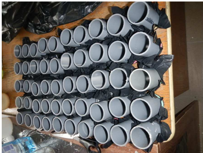
3.5 pav. Gruntbetonio bandinių formos
