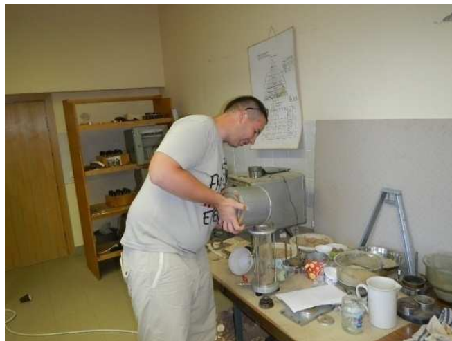
3.5 pav. Grunto granulometrinės sudėties nustatymas
