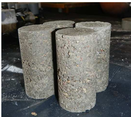
3.14 pav. Išimti bandiniai po 7 ir 28 parų laikymo
