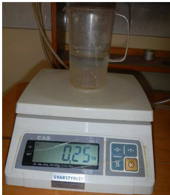
3.10 pav. Svarstyklėmis pasveriamas reikiamas vandens kiekis
