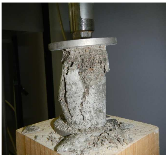
3.29 pav. Sugniuždytas bandinys
