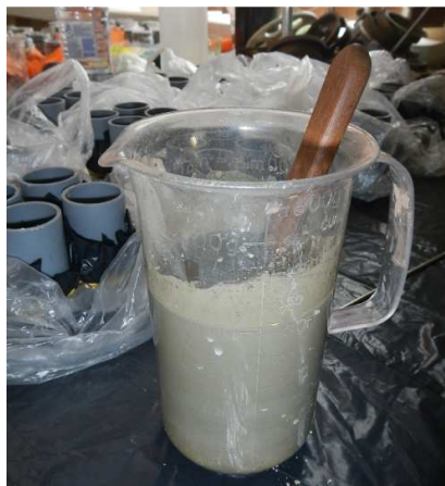
3.11 pav. Paruoštas vandens, cemento ir smėlio mišinys
