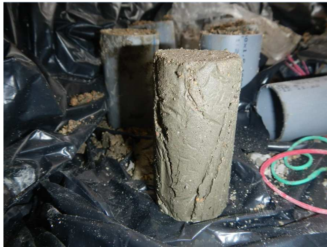
3.8 pav. Išimtas bandinys su smėlio, vandens ir cemento mišiniu (viduje įklota polietileninė plėvelė)
