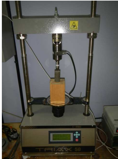
3.15 pav. Triašio slėgio aparatas
