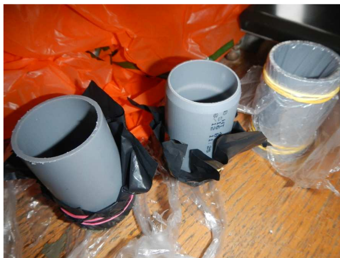
3.6 pav. Gruntbetonio bandinių formos su įklota polietileno plėvele
