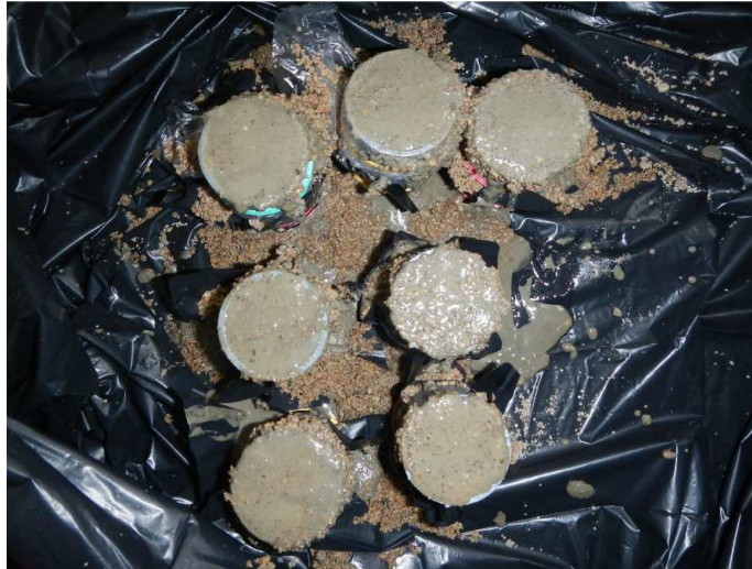
3.7 pav. Formos su smėlio, vandens ir cemento mišiniu
