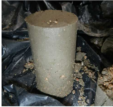
3.9 pav. Išimtas bandinys su smėlio, vandens ir cemento mišiniu (vidus išteptas aliejumi)
