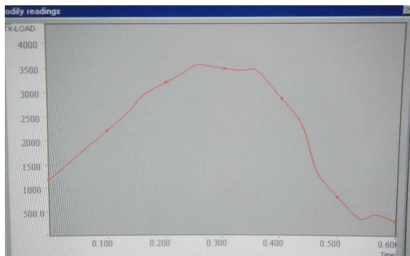
3.28 pav. Apkrovos kitimo grafikas, išvalytas vanduo (buvo užterštas buitiniėmis nuotekomis) (0,8:1)
