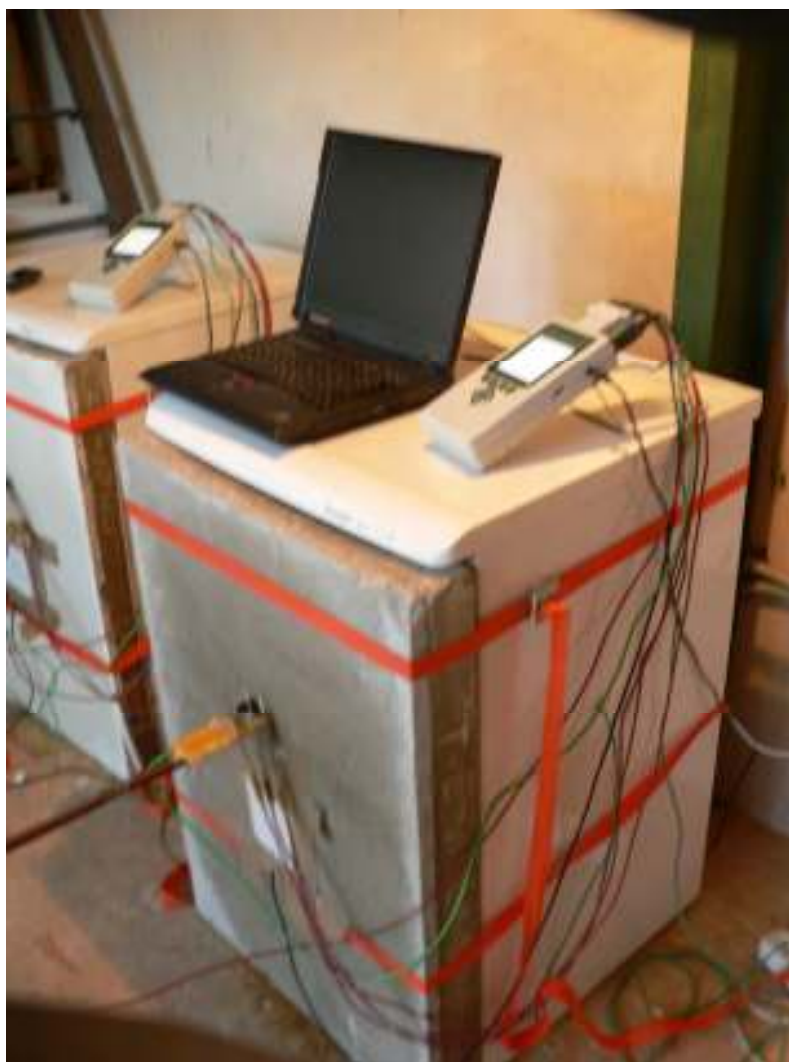
13 pav. Bandinys pritvirtintas prie šaldiklio
