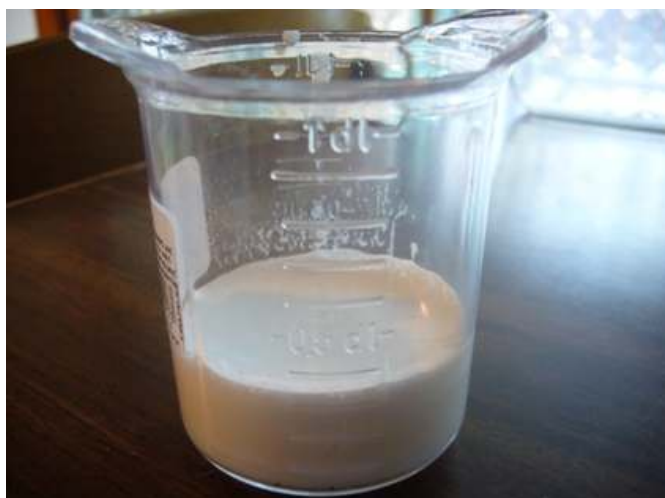
11 pav. Grunto ir dažų kiekio matavimas menzūra
