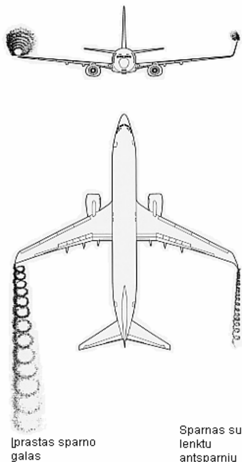
2.12 pav. Oro sūkuriai sparno gale su ir be lenktų antsparnių
