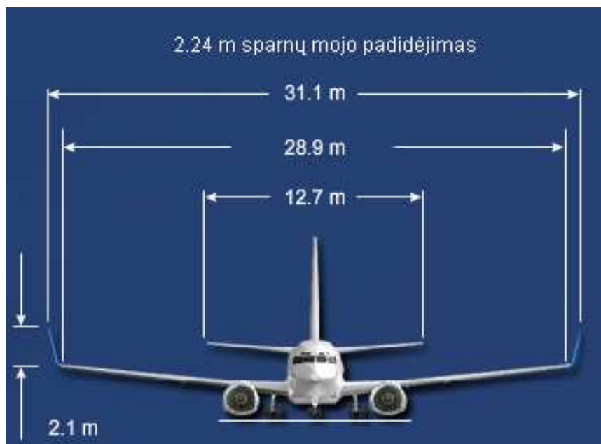
3.6 pav. Lėktuvų B737-300/500 fizinių parametrų pasikeitimas sumontavus lenktus antsparnius
