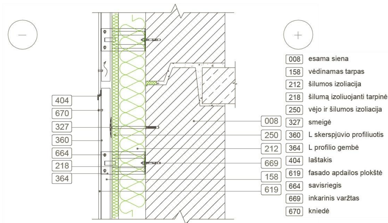
1.19 pav. Vėdinama sienų šiltinimo sistema (Ignatavičius, Skrodenis 2011)
