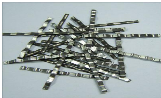
1.10 pav. Gofruotas plieno plaušas iš plieninės skardos
