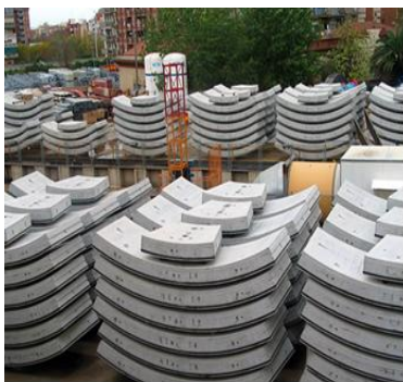
1.11 pav. Plieno ir polipropileno plaušu armuotų segmentų naudojimas tiesiant tunelius Fig. 1.11. The usage of steel and polypropylene fiber reinforced segments for the construction of tunnels
