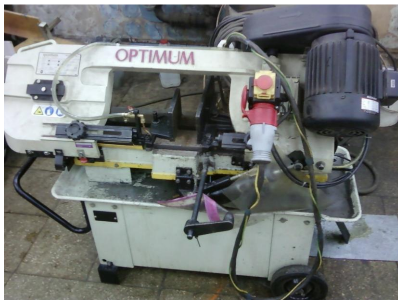
2.1 pav. Aušinamas juostinis pjūklas OPTIMUM
