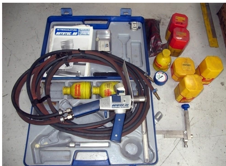
2.4 pav. Dujinio purškimo pistoletas „Rototec 80“
