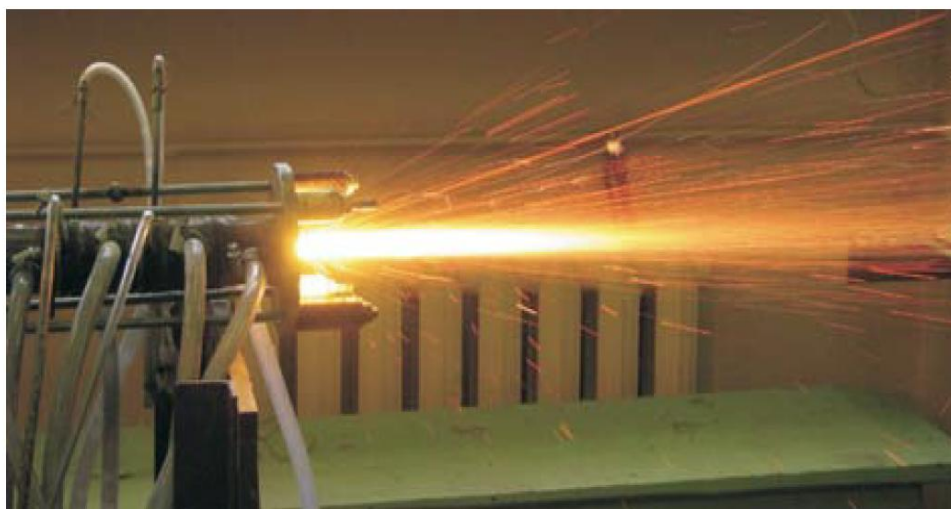
2.3 pav. Veikiantis pastovios srovės linijinis plazmos generatorius (Lietuvos energetikos...2012)
