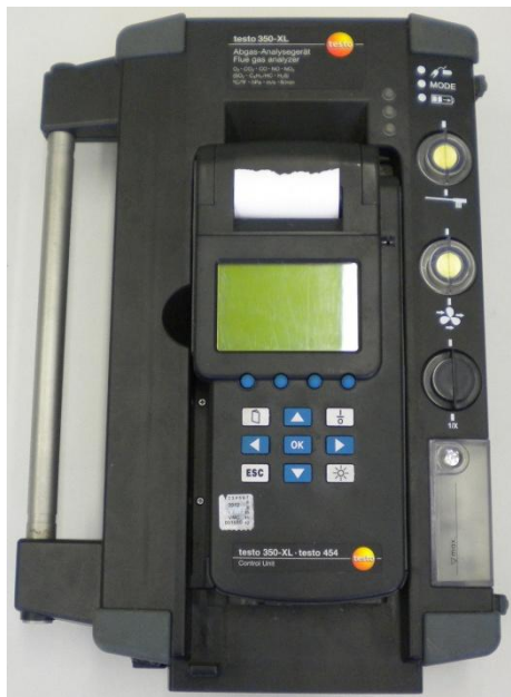
2.10 pav. Dujų analizatorius Testo 350 XL (Autoriaus nuotrauka)
