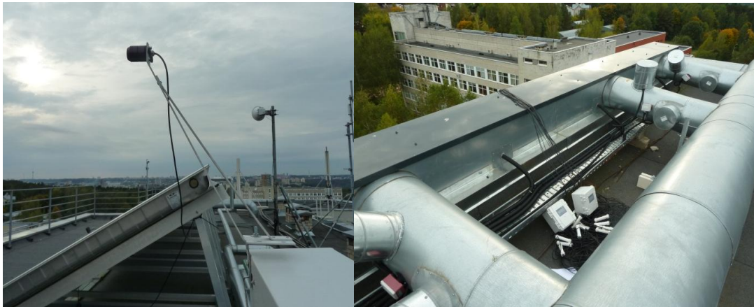
12 pav. Matavimo įranga (kairėje – pirometras; dešinėje – termoporos ir anemometrai)
