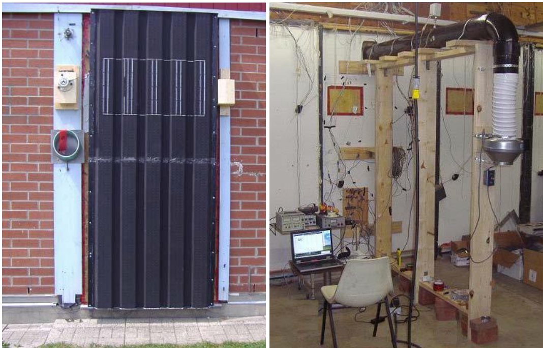
4 pav. Delisle eksperimentinio tyrimo modelis (kairėje – kolektoriaus išorė su PV elementais, dešinėje – matavimo įranga [21])
