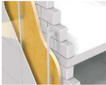
1.19 pav. Putų poliuretaną naudojamas išoriniam šiltinimui už pakabinamo fasado
