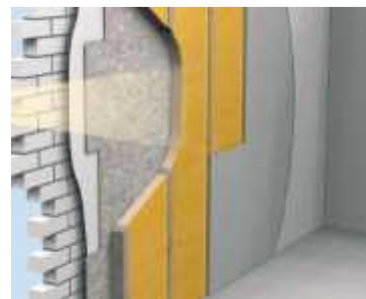
1.22 pav. Putų poliuretaną naudojamas medinių karkasinių pastatų šiltinimui iš vidaus
