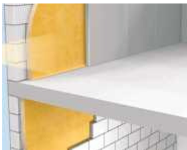
1.21 pav. Putų poliuretaną naudojamas lauko sienai šiltinimui iš vidaus
