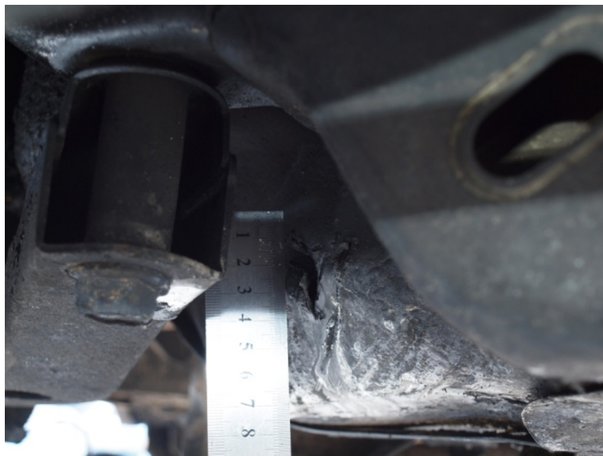
Foto Nr.19. Automobilio VW PASST, valstybinis numeris T00000 ant kuro bako, apačioje iš dešinės pusės yra kiauryminis, 0,4 m. ilgio ir 0,1 m. pločio, pailgas, pažeidimas
