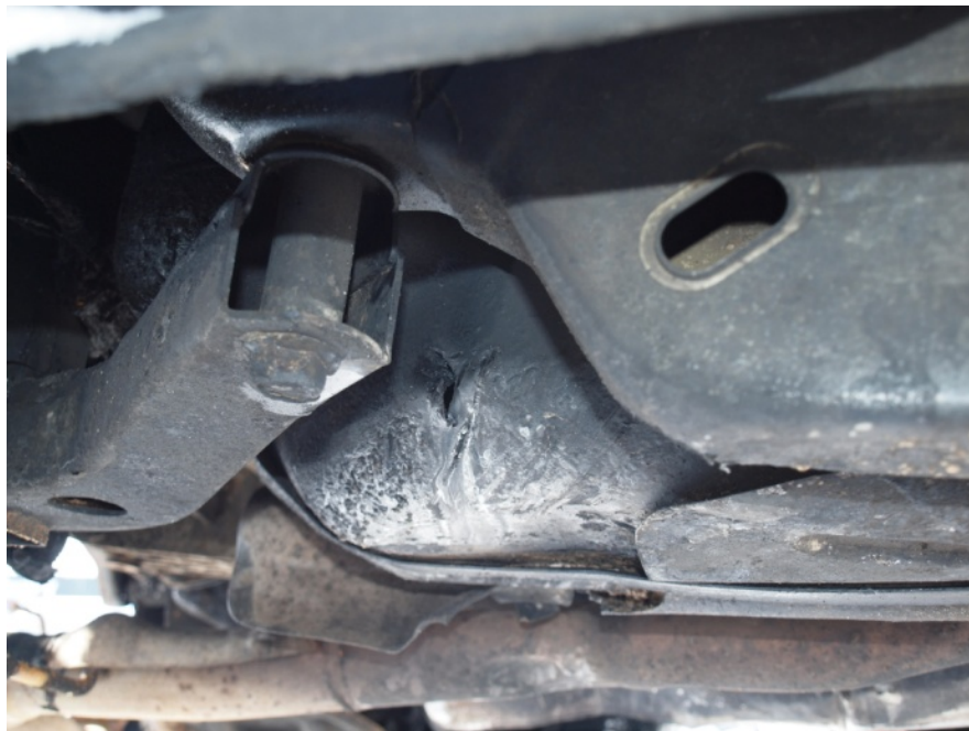
Foto Nr.18. Automobilio VW PASST, valstybinis numeris T00000 ant kuro bako, apačioje iš dešinės pusės yra kiauryminis, 0,4 m. ilgio ir 0,1 m. pločio, pailgas, pažeidimas
