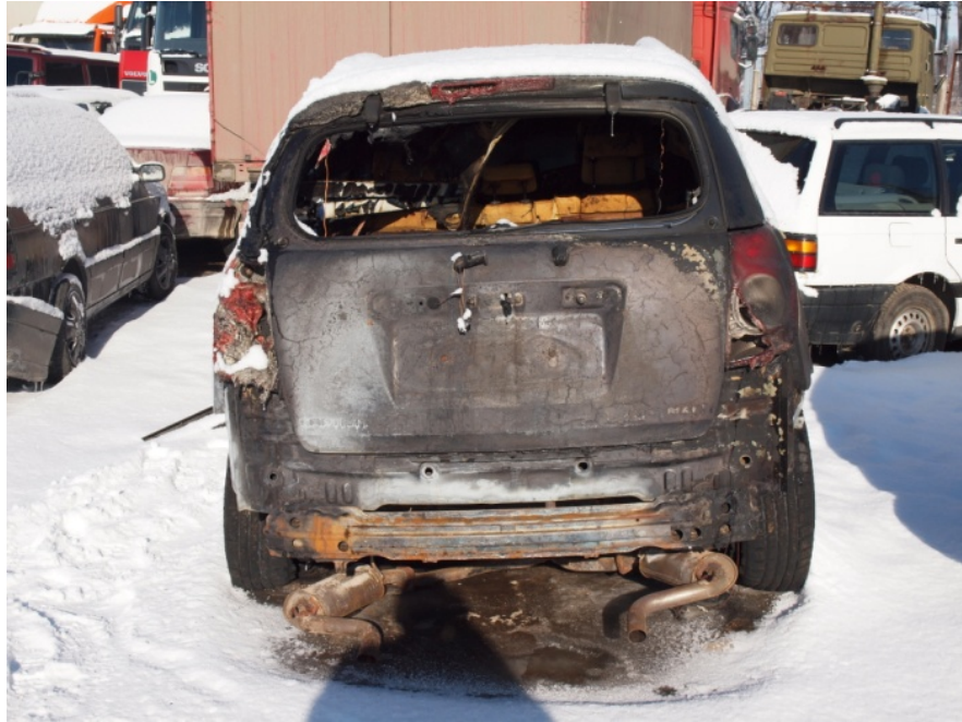
Foto Nr.13. Automobilio VW PASST, valstybinis numeris T00000 apdegusios galinės dalies vaizdas
