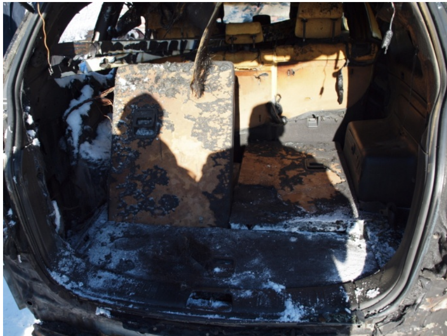
Foto Nr.14. Automobilio VW PASST, valstybinis numeris T00000 bagažinės skyriaus viduje, kairėje pusėje apdegusi plastmasinė apdaila. Bagažinė termiškai paveikta viduje.
