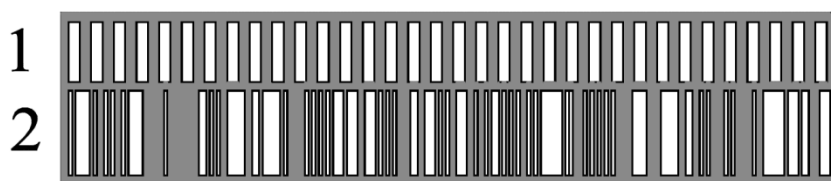
1.5 pav. Periodinė skalė su kodiniu takeliu 1 – periodinės struktūros takelis, 2 – kodinės struktūros takelis
