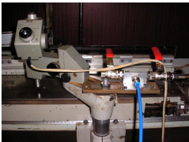
4.11 pav. Išstatymo mikroskopas ir suslėgto oro valdymo sklendės
