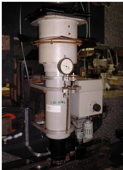
4.1 pav. Dalijimo mašinos optika su indikatoriumi
