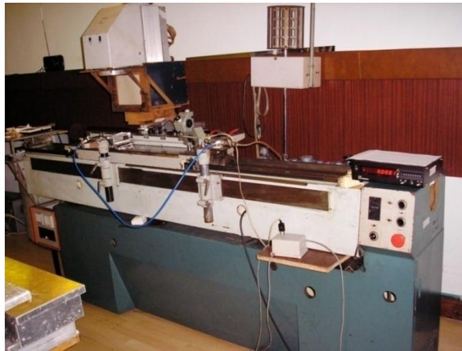
4.9 pav. Dalijimo mašina, turinti fragmento prispaudimo mechanizmą
