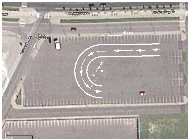
44 pav. Iš palydovo daryta „Siemens arena“ aikštelės nuotrauka su nubraižyta įsibėgėjimo, įvažiavus į posūkį, iki 40 km/h schema
