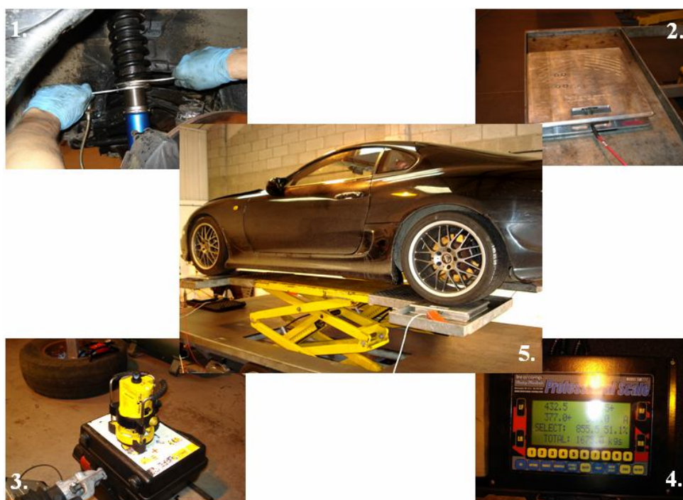
6 pav. Sportinio automobilio pakabos reguliavimas ir svėrimas: 1) amortizatorių reguliavimas; 2) svarstyklės; 3) prietaisas automobilio pasvyrimo kampui horizontalios plokštumos atžvilgiu nustatyti (rotacinis lazeris „Stabila lapr-100”); 4) svarstyklių reikšmės; 5) automobilis, pakeltas ant svėrimo ir pakabos reguliavimo stendo
