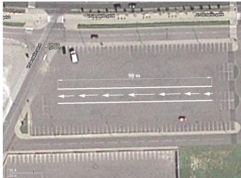
43 pav. Iš palydovo daryta „Siemens arena“ aikštelės nuotrauka su nubraižyta staigaus įsibėgėjimo iki 40 km/h ir staigaus stabdymo schema
