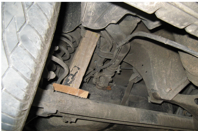
9 pav. „Nissan Primera“ automobilio pakabos ir kėbulo įtvirtinimas medinėmis sijomis
