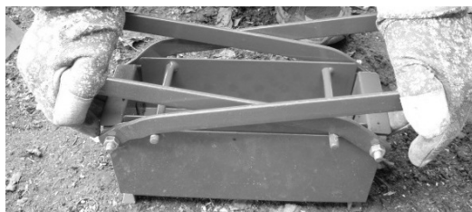
3.1 pav. Biokuro briketų (220 x 100 x 70 mm) gamybos įrenginys Fig. 3.1. Device for biofuel briquettes (220 x 100 x 70 mm) production
