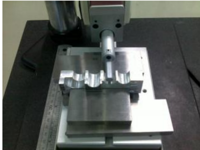
3.16 pav. Paviršiaus šiurkštumo matavimas
