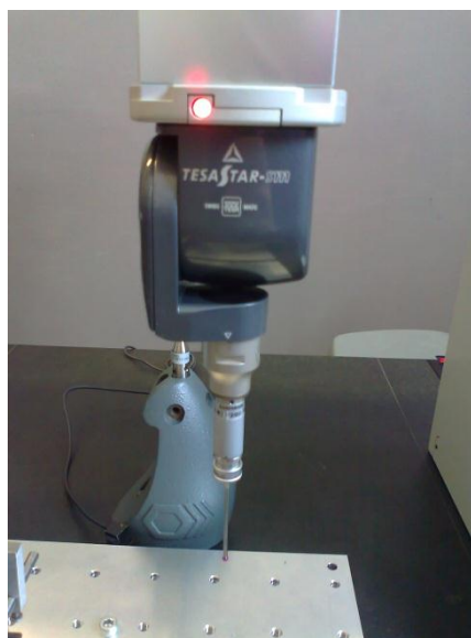
3.10 pav. Matavimo galvutė su pjekokristaliniu jutikliu
