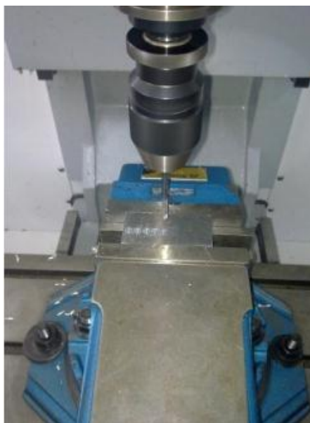
3.5 pav. Ruošinys, įtvirtintas spaustuve
