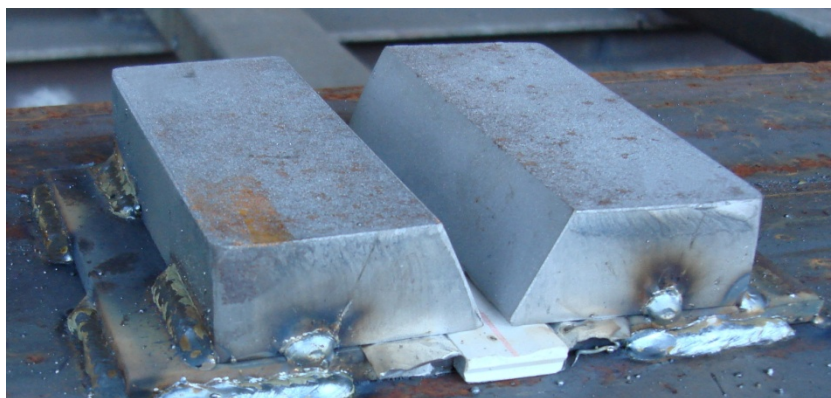
2.2 pav. Bandinys prieš suvirinimą Fig. 2.2. The specimen before welding
