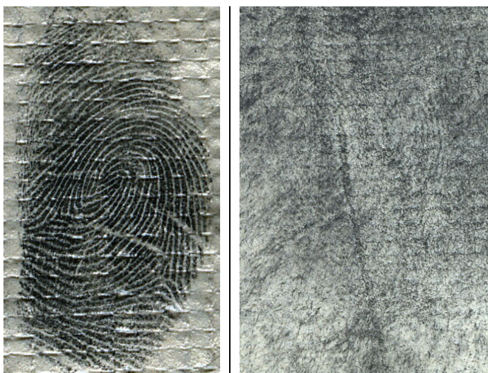
16 nuotrauka. Rankos piršto pėdsakas, išryškintas ant lipnios juostos lipniosios pusės: kairėje – šlapių miltelių suspensija, dešinėje – juodais daktiloskopiniais milteliais.
