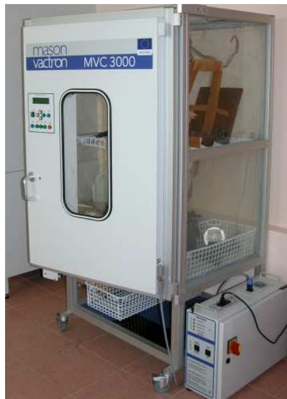
9 nuotrauka. Cianoakrilato spinta MASON VACTRON MV3000 (naudojama KTC Daktiloskopinių tyrimų skyriuje).
