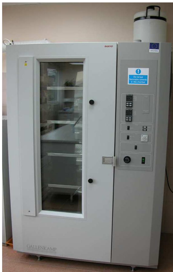
6 nuotrauka. DFO ir ninhidrino spinta SANYO GALLENKAMP PLC FDC060 (naudojama KTC Daktiloskopinių tyrimų skyriuje).
