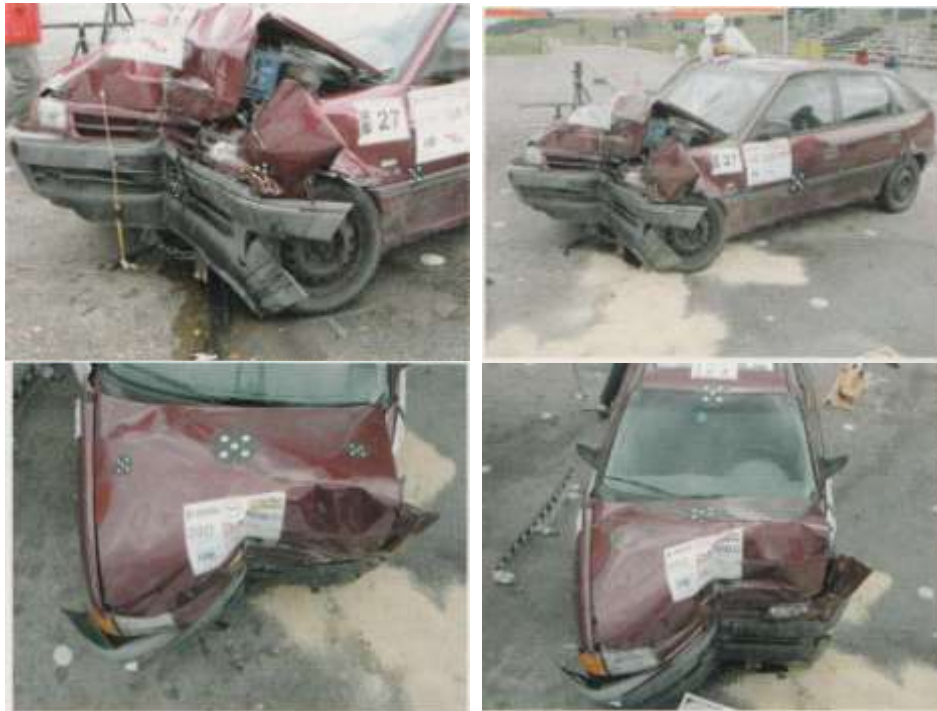
17 pav. Automobilio „Opel Astra“ deformacijų detalus vaizdas
