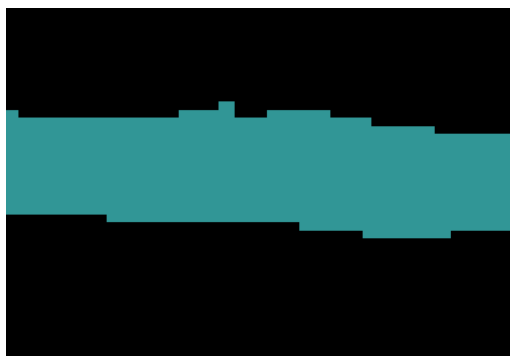
55 pav. Metalų takelio kraštų nelygumai, gaunami filtravimo metu
