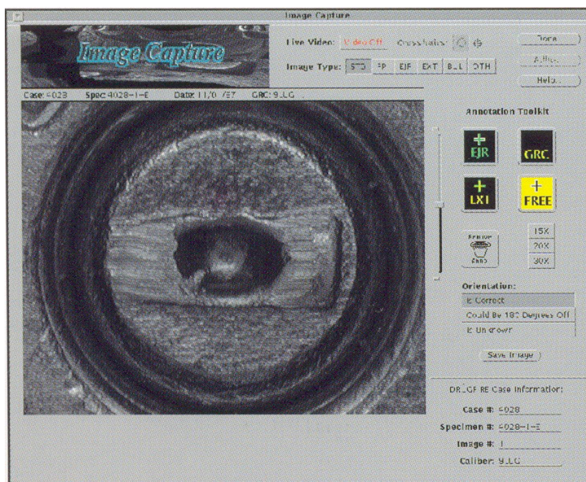
Specializuotu mikroskopu SICM fiksuojamas tūtelės kapsulės vaizdas
