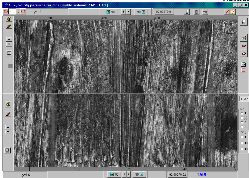
Vamzdžio kanalo pėdsakų palyginimas ant kulčių
