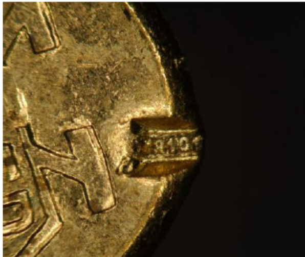
.22 kal. pistoleto Ruger MK I skiltuvo pėdsakas su išgraviruotu kodu
