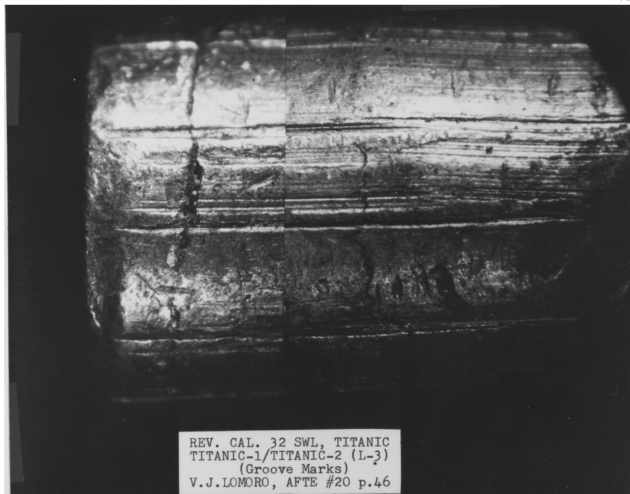
Graižtvų dugno prie trečiojo graižtvų lauko pėdsakų palyginimas ant kulų iššautų iš dviejų revolverių TITANIC
