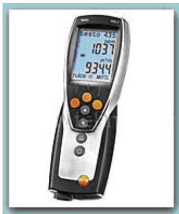
20 pav. Dagiavfunkcis matavimo prietaisas „Testo 435“
