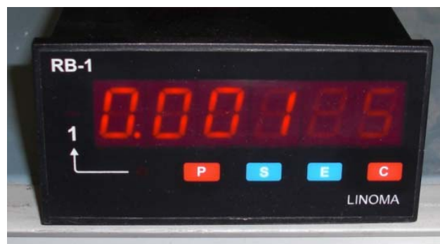
5.8 pav. Fotoelektrinio kampų keitiklio impulsų registratorius LINOMA RB-1
