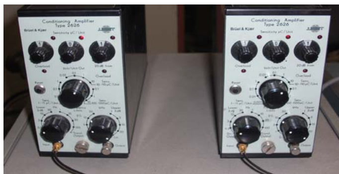
5.9 pav. „Brüel & Kjær“ pagreičio jutiklių (akselerometrų) stiprintuvai 2626
