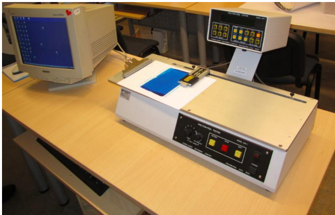
16 pav. Trinties koeficientų matavimo įrenginys „Thwining – Albert“ FPDAS 1.0.0.1
