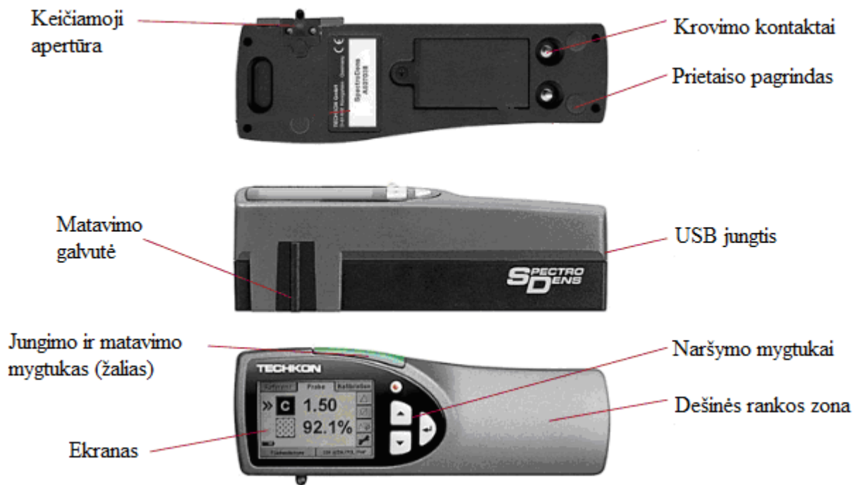
8 pav. Spektrodensitometras „Techkon SpectroDens“
