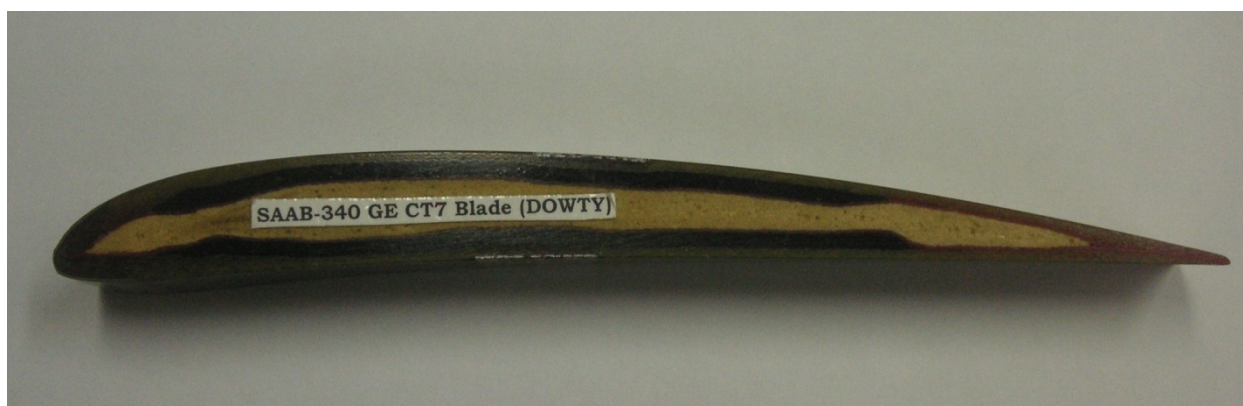
16 pav. SAAB-340 sraigto išpjova
