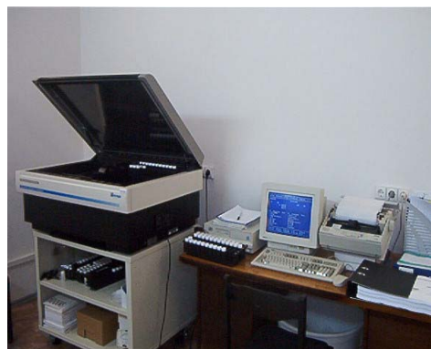
2.3 pav. Radiometras UMF (mažo fono įrenginys) su SBT–13 tipo skaitikliu, naudotas 1965–2003 metais beta dalelėms matuoti (kairėje), skysčio scintiliacijos skaitiklis Tri–Carb 2770 TR/SL, naudotas 1996–2003 metais ^{90}\text{Sr} aktyvumui nustatyti (dešinėje)
