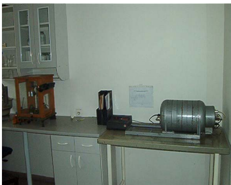
2.3 pav. Radiometras UMF (mažo fono įrenginys) su SBT–13 tipo skaitikliu, naudotas 1965–2003 metais beta dalelėms matuoti (kairėje), skysčio scintiliacijos skaitiklis Tri–Carb 2770 TR/SL, naudotas 1996–2003 metais ^{90}\text{Sr} aktyvumui nustatyti (dešinėje)
