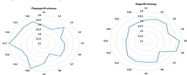
Малюнок 1 - Зміна товщини стінки гільзи 154x13,7 мм
