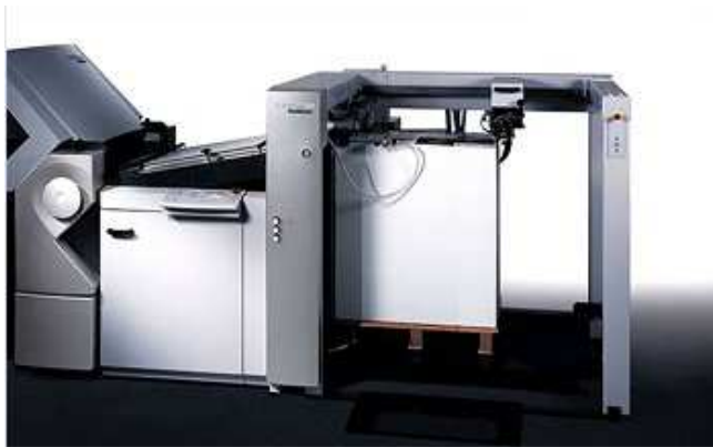
14 pav. Lankstymo mašinos „Heidelberg Stahlfolder TH/KH“ popieriaus tiekimo mechanizmas
