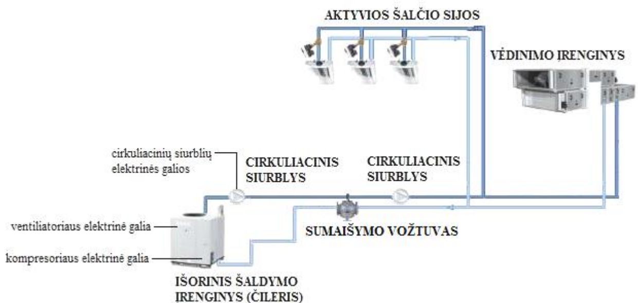
6 pav. Vandeninės aktyviųjų vėsinamųjų sijų sistemos principinė schema
