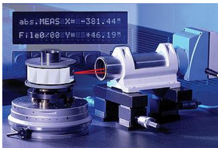
1.7 pav. Precizinio staliuko tikslumo matavimas poligonu/autokolimatoriumi
