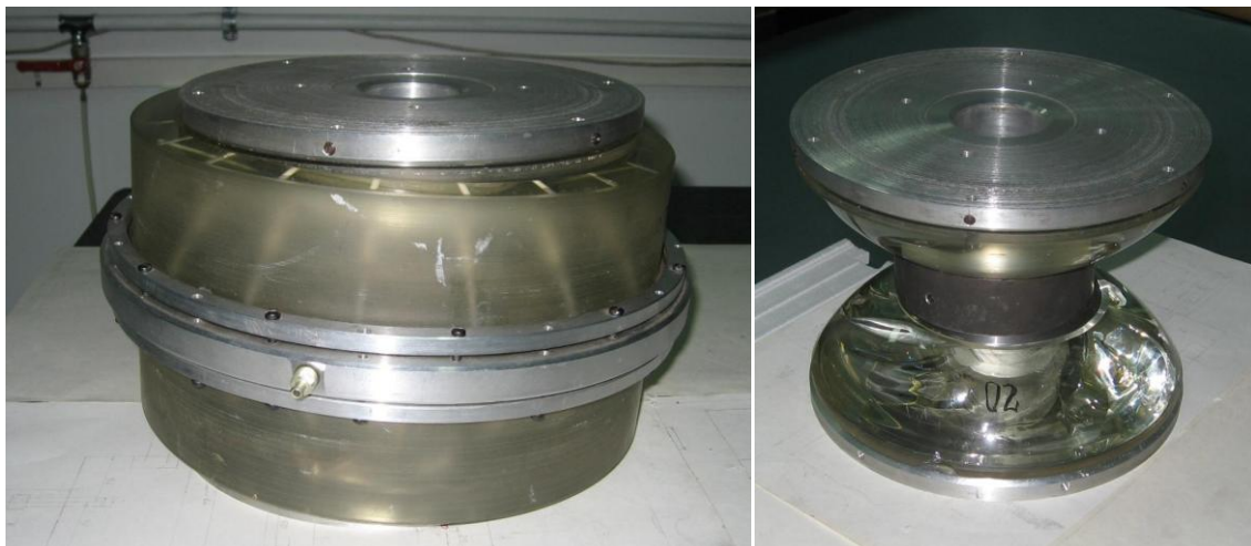
1.14 pav. Suklio ir jo veleno su sferiniais darbiniais paviršiais vaizdas
