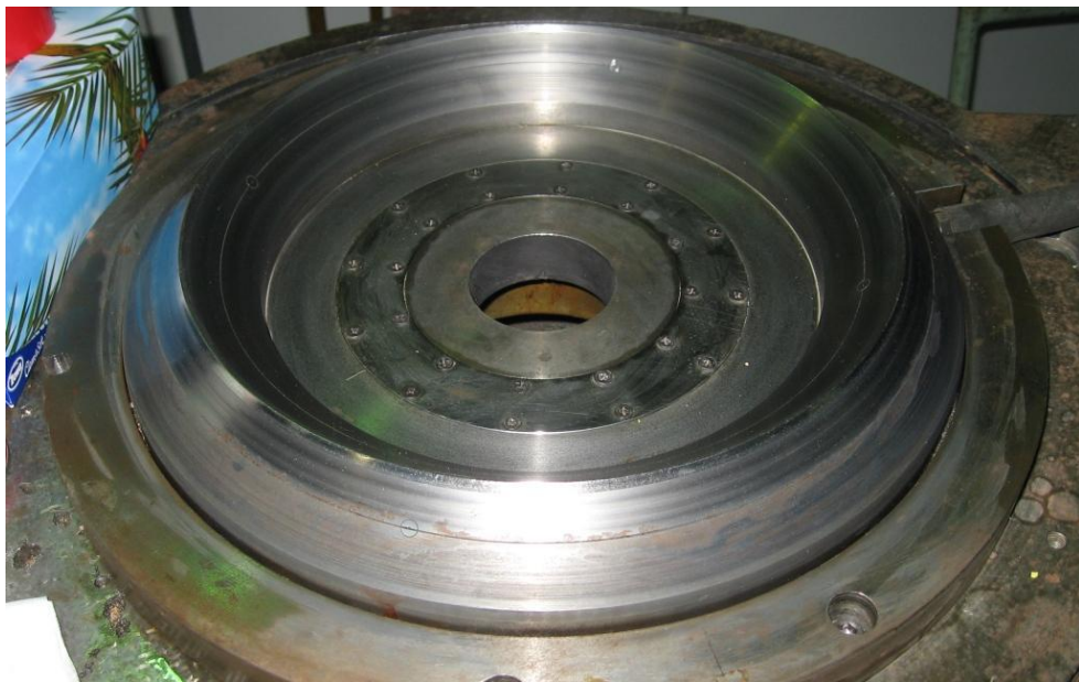
1.12 pav. Suklio su V formos kūginiais paviršiais bendras vaizdas
