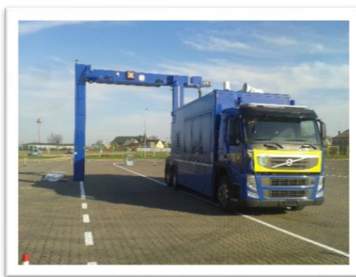
10 pav. Mobili rentgeno kontrolės sistema Kybartų kelio poste 123 .
